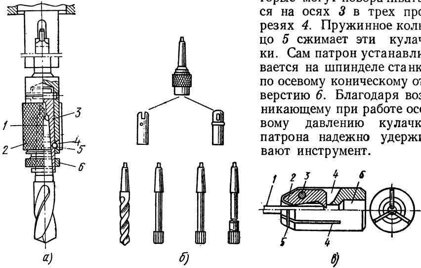
Рис. 304. Быстросменные патроны: а, в — устройство, б — последовательность установки инструмента
