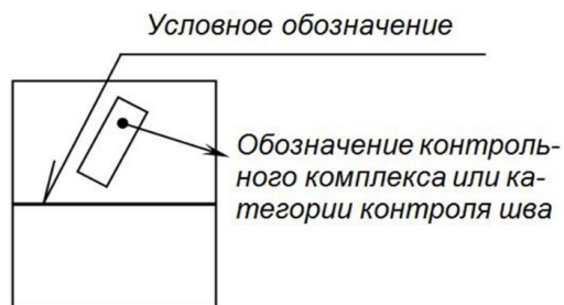
Рисунок 4.5 – Обозначение контрольного комплекса или категории контроля шва на чертеже.
