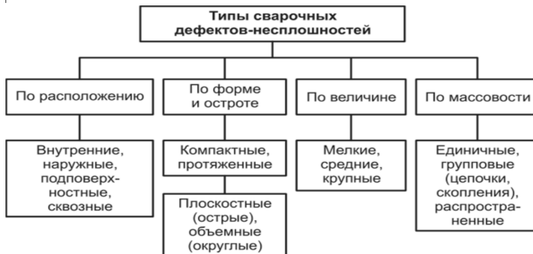
Рисунок 9.1 – Классификация дефектов сварных швов
