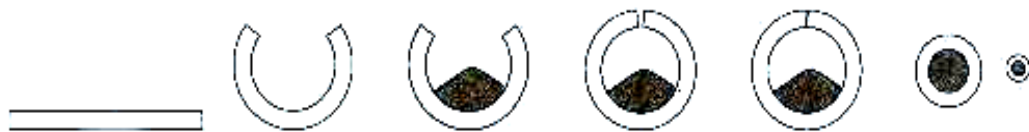
Рисунок 8.11 – Технологические операции при изготовлении бесшовной ПП
